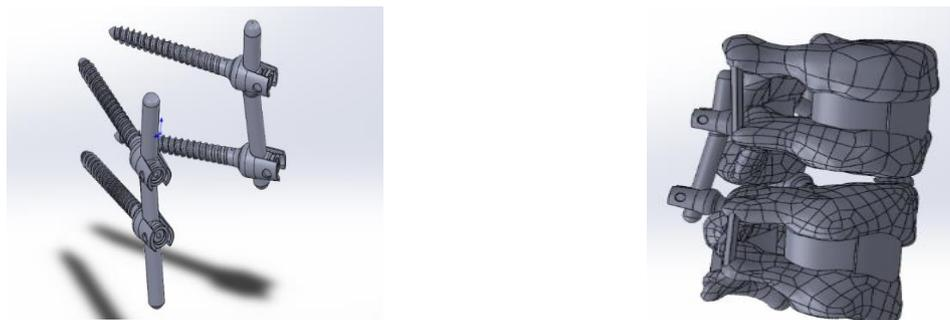
Рисунок 6 – Интерфейсы программы SolidWorks : а) спинальный эндокорректор; б) сборка двух двигательных элементов позвоночника и эндокорратора
