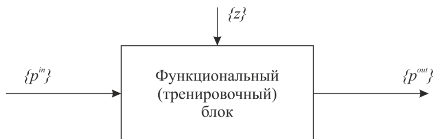
Рисунок 3 – Тренировочный процесс, реализуемый на функциональном блоке. p^{in} – совокупность параметров, характеризующих исходное состояние блока; p^{out} – совокупность параметров, характеризующих конечное состояние блока; z – воздействия обучаемого
