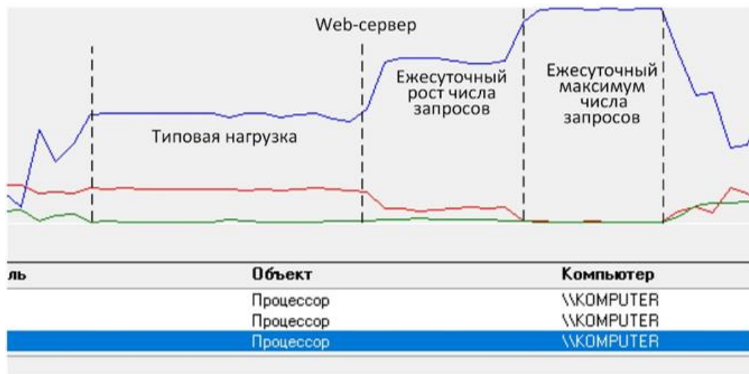
Рисунок 1 – Пример периодических шаблонов рабочей нагрузки: a – выполнение контейнера Kubernetes; б – ежесуточное функционирование виртуализированного веб-сервера
