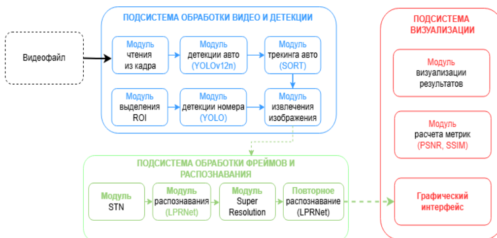
Рисунок 1 – Архитектура программного комплекса Figure 1 – Software architecture
