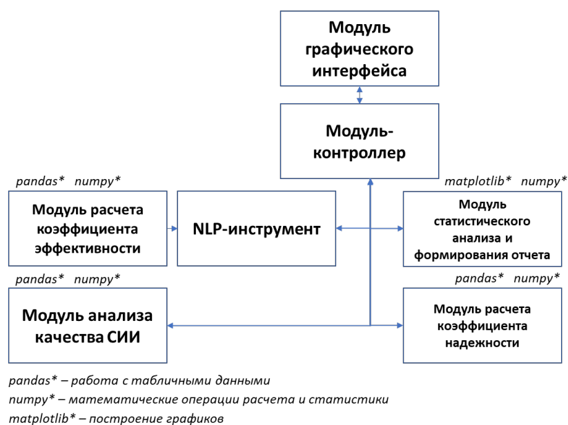
Рисунок 3 – Схема работы программы оценки коэффициентов надежности, эффективности и качества
