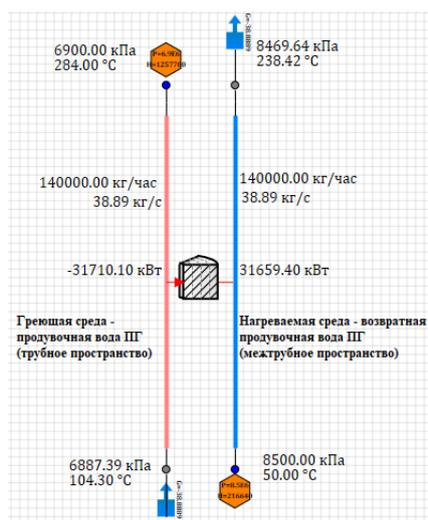
Рисунок 1 – Расчетная модель теплообменника в SimInTech
